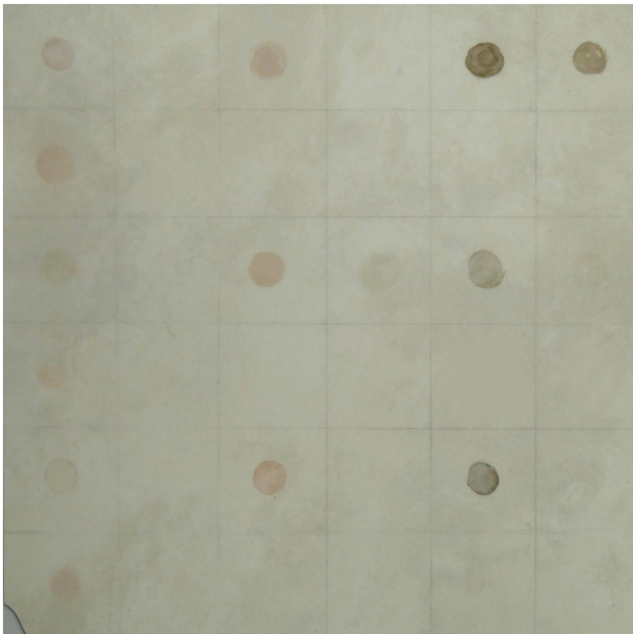
Abbildung 7: PU Anticolor Seidenglänzend, Dr. Schutz; Einwirkzeiten 120 min, 60 min, 30 min
