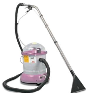
**D Sprühboy 2000** | Tiefenreinigung durch Sprühen und direktes Absaugen. Die Reinigungslösung wird durch den Sprühsauger in die Tiefe des Flors gesprüht, der Schmutz gelöst und abgesaugt. Klebrige Rückstände werden restlos ausgespült.
